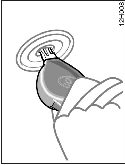
**Motor blokaj (immobilayzır) sistemi** araç hırsızlığını önlemek için geliştirilmiş bir sistemdir. Anahtarı kontak anahtarının deşiliğine soktuğunuz zaman anahtarın sahip olduğu transponder (radio vericisi) araca elektronik bir kod gönderir. Aracın motoru yalnızca transponder'in gönderdiği elektronik kod, aracın hafızasında kayıtlı kimlik koduya aynı ise çalışacaktır.
